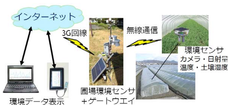
図2 ミニパイプハウス環境センサシステム
