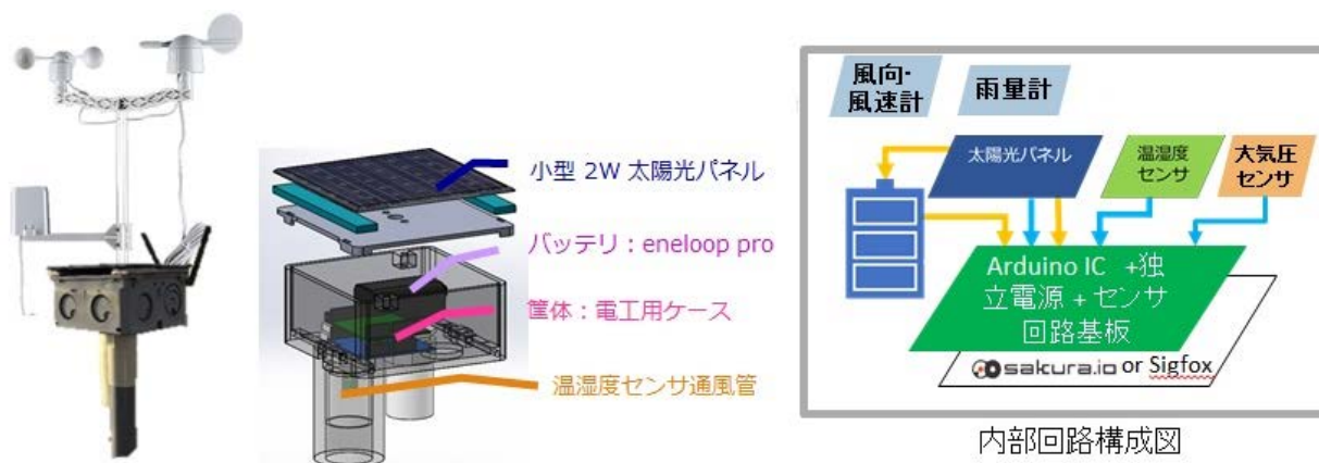
図1 IoT環境センサ外観と内部構成図
