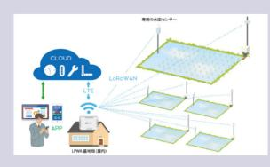
漁業支援を目的として、海上に漁業や水産資源の生育にかかわるデータの計測装置を設置し、計測データをLoRa通信でクラウドへ送信する。これらの駆動に必要な電源としてソーラー
