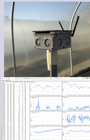
図1簡易ウェザーステーション 図2ハウスセンサシステム 図3水位計システム
