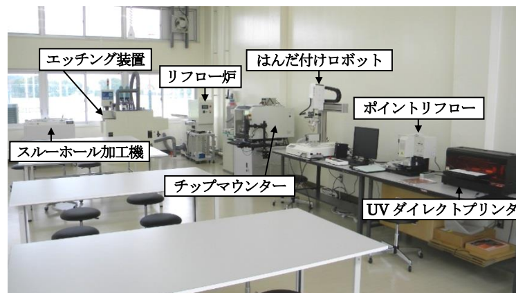
ファブラボに導入された電子回路製作のための各種設備
