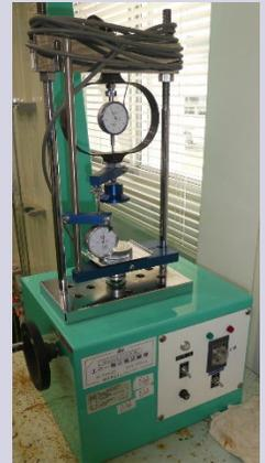
一軸圧縮試験試験機
