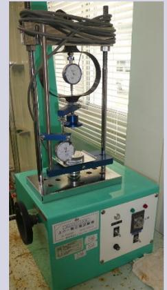
一軸圧縮試験試験機
