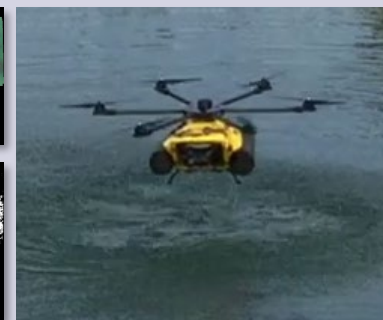
図5 着水可能なマリンドローン
