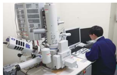
電子顕微鏡による金属表面観察 [Observation of metal surface by electron microscope]
