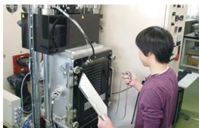
パルス通電焼結機を用いた アルミナセラミックスの焼成 [Sintering of alumina ceramics by pulsed current sintering machine]
