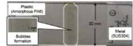
ステンレスとPET樹脂の異材接合
