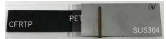
PET樹脂(絶縁物)を介したSUS304とCFRTP(CFRP)の異材接合
