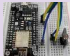
図3 ESP8266とフォトレジスタによる光度測定システム
