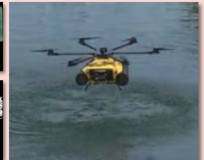
図5 着水可能なマリンドローン
