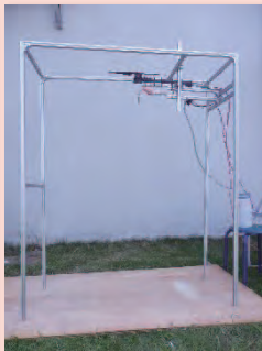
図2 散布実験装置
