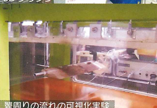
翼周りの流れの可視化実験
