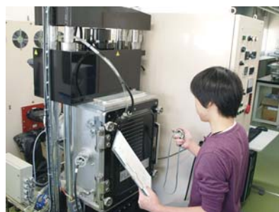
パルス通電焼結機を用いた アルミナセラミックスの焼成 [Sintering of alumina ceramics by pulsed current sintering machine]
