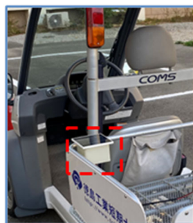
図 2 GPS 装置装着状態
