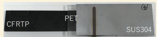
PET/PET樹脂(絶縁物)を介した SUS304とCFRTP(CFRP)の異材接合
