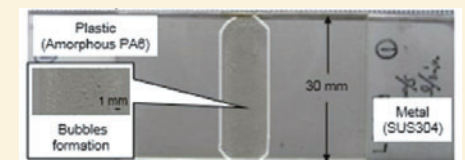
ステンレスとPET樹脂の異材接合
