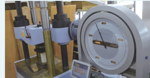
万能試験機を使ったテストピースの圧縮試験
