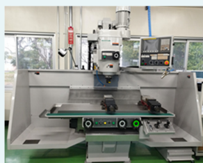
NCフライス盤 山崎技研 YZ-350NCR
