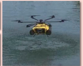
図5 着水可能なマリンドローン
